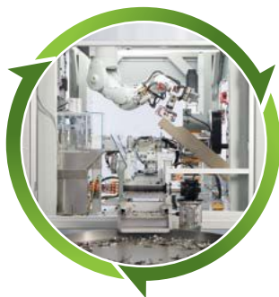
Daisy, la dernière innovation d'Apple en matière de récupération de matériel, peut démonter neuf modèles différents d'iPhone pour récupérer des matériaux précieux que les recycleurs traditionnels n'arrivent pas à recueillir. Image gracieusement fournie par Apple Inc.
